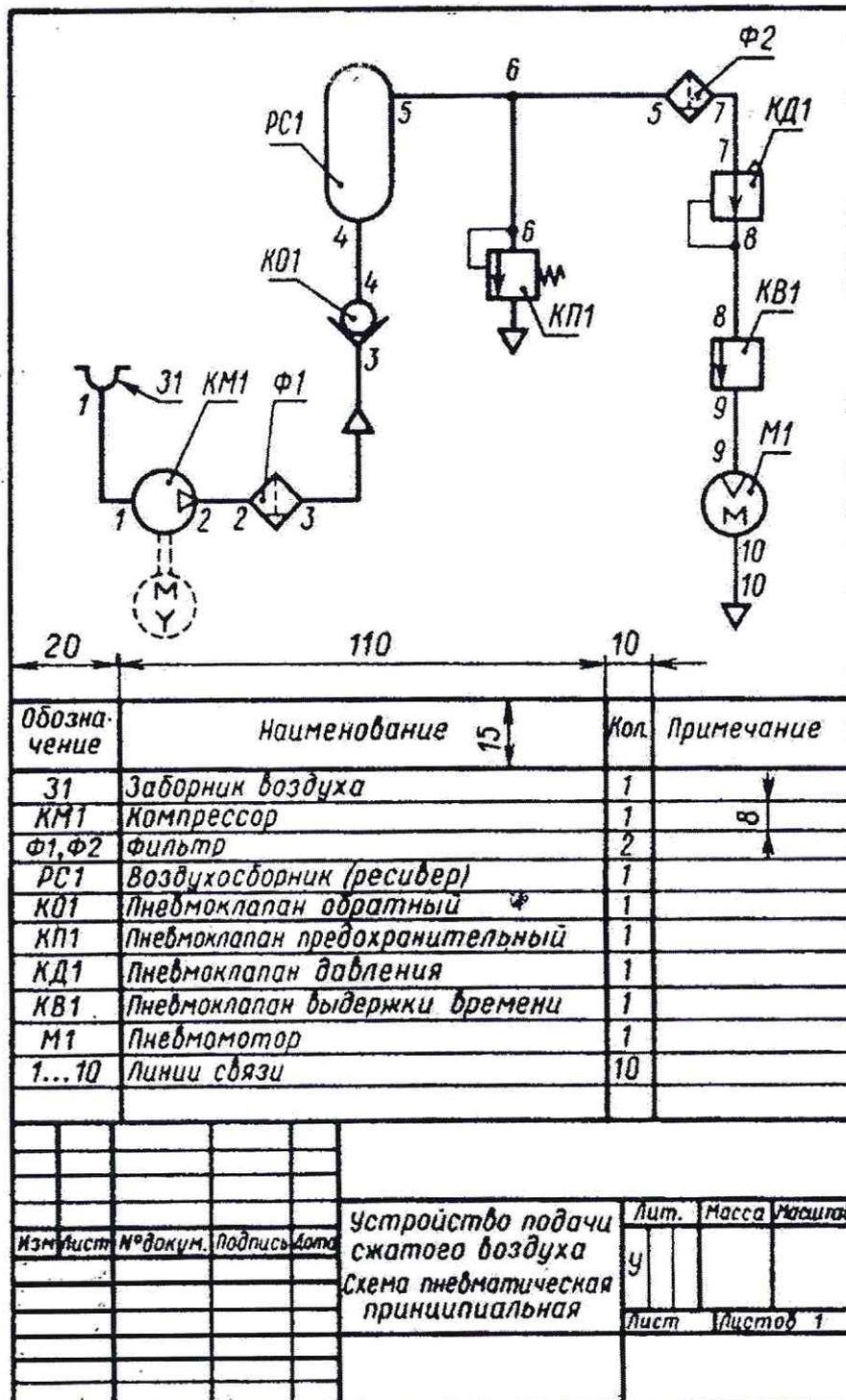
Рисунок 3- устройство подачи сжатого воздуха
