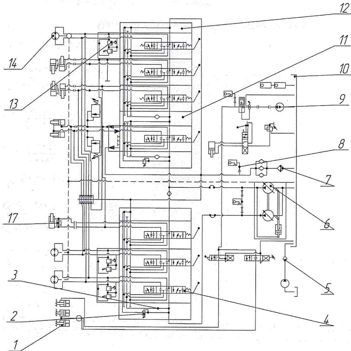
Рисунок 4 – Гидравлическая схема экскаватора ЭО -4124
