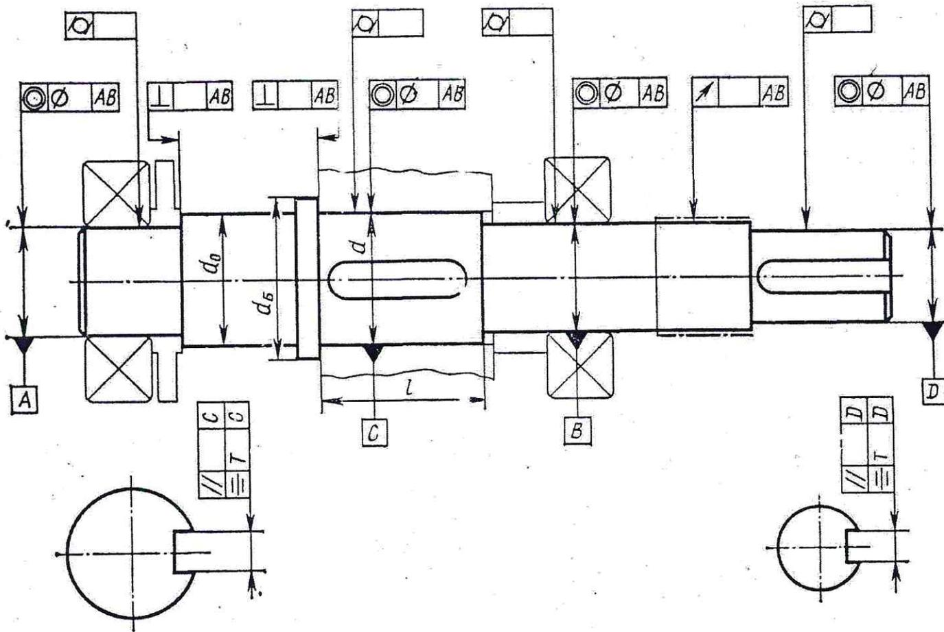
Рисунок 2 – Отклонения от форм поверхности вала
